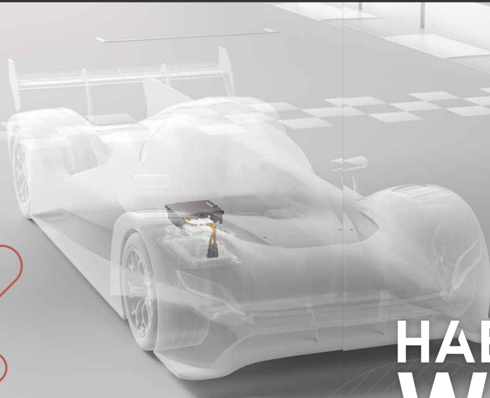
Bei den 24 Stunden von Daytona gehen erstmals die neuen LMDh-Autos von Porsche, Cadillac, BMW und Honda-Nobelmarke Acura an den Start. In den Prototypen für die Erste Liga der IMSA und der Sportwagen-Langstrecken-WM arbeitet ein Einheits-Hybridsystem von Bosch. Wie funktioniert die neue Nachhaltigkeitstechnik?
